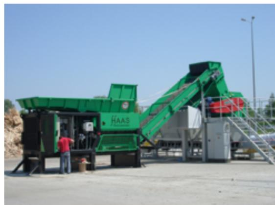
con motor de 37 kW para troncos con un diámetro máximo de 250 mm.
