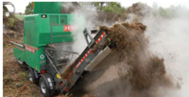
menos finos en astilla de gran tamaño. Procesa árboles y arbustos enteros de hasta 80 mm de diámetro (60 mm en frondosas). La salida por tubo de descarga puede girar 360°.
