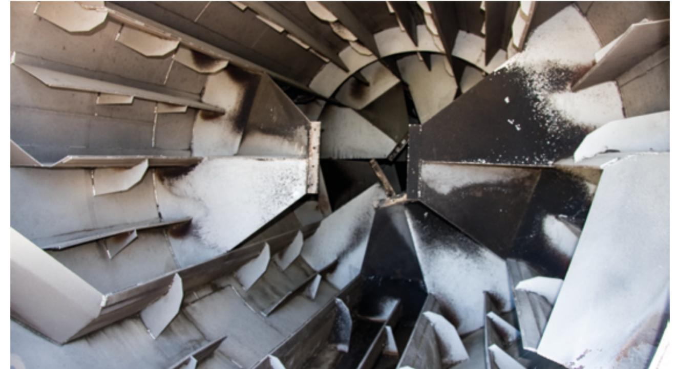
En la imagen, interior de un **secadero rotativo** con sistema Multivolteo.
