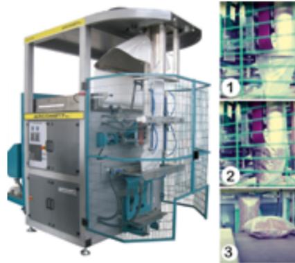
controla el peso para la dosificación. Además, el motor con variador de frecuencia aumenta o disminuye la velocidad de cinta según la carga/consigna necesaria.
