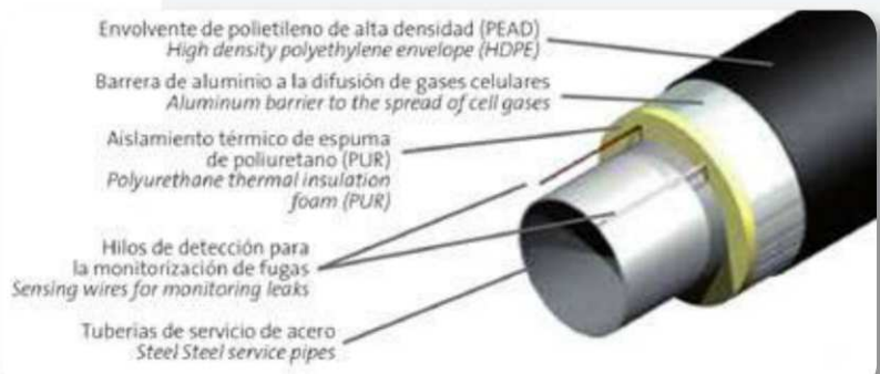
Detalle de tubería preaislada LOGSTOR con los cables de detección de fugas Detail of pre-insulated LOGSTOR pipe with leak detection cables
