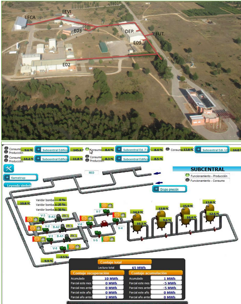
Ilustración 18 Vista general de la distribución de la red térmica del CEDER y captura de software de gestión. Fuente CIEMAT
