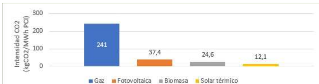
Ilustración 5. Huella de carbono de diferentes tecnologías de generación térmica. Fuente: ADEME, INUK, IPCC.
